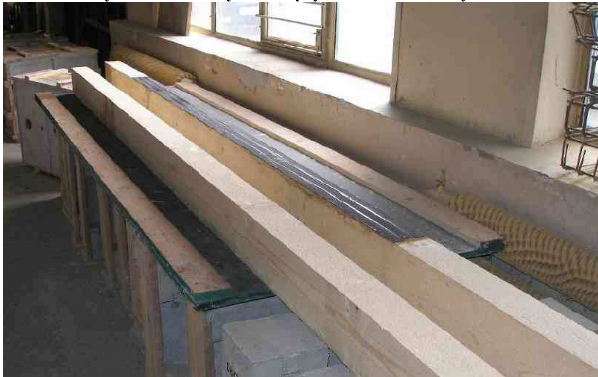
Obr. 2: Zátěžová zkouška dřevěného nosníku zesíleného systémem Letoxit Silosyst
